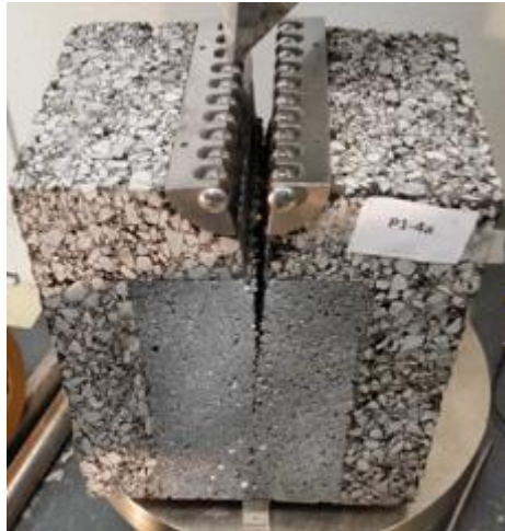
Figure IV-7 Etat de l'interface des éprouvettes P1 non renforcées testées par le WST
