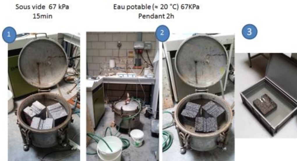
Figure V-1 Protocole de saturation des éprouvettes pour les essais WST sous eau
