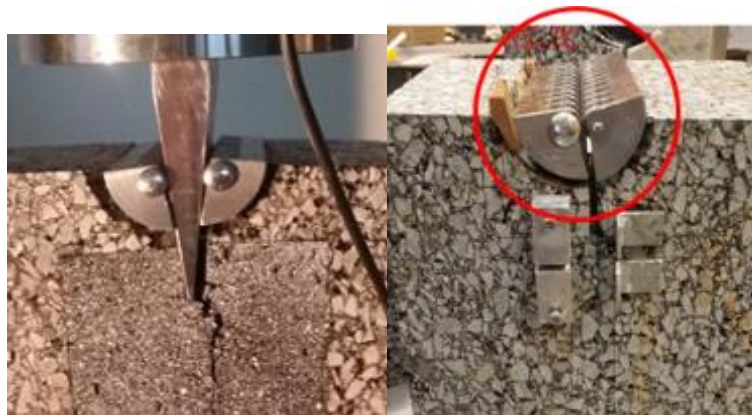
Figure IV-8 Blocage du coin durant l'essai des éprouvettes P1 non renforcées
