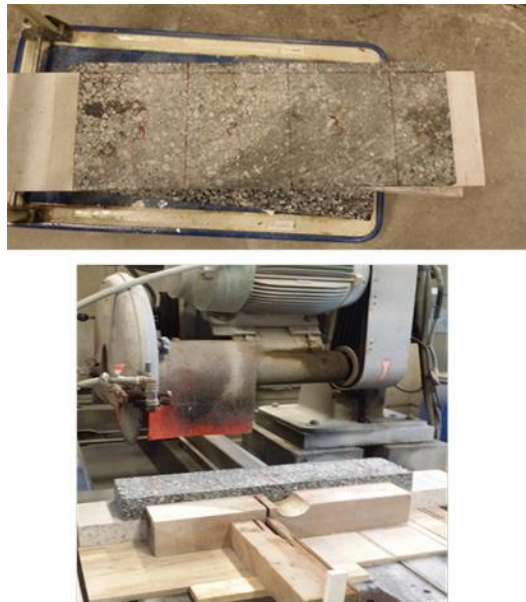
Figure III-16 Préparation des éprouvettes 1GT \perp
