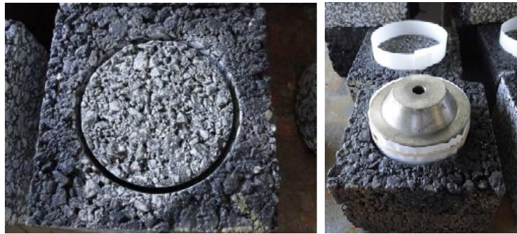
Figure C-26 Préparation des éprouvettes TAT (images COLAS)
