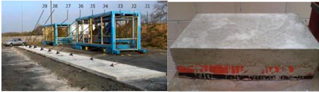
Figure III-1 a) Planche expérimentale FABAC de la thèse de (Pouteau, 2004) b) Blocs B/N fabriqués en laboratoire lors de la thèse (Hun, 2012)
