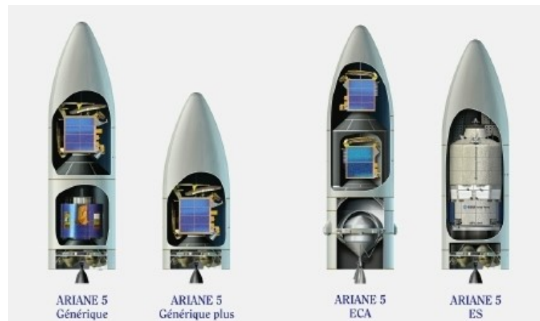
FIGURE 3 – Représentation de la partie haute d’Ariane 5. Source : CNES.
