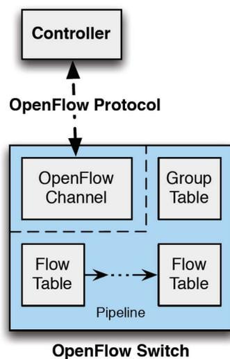
FIGURE 1.3 – Composants d'un commutateur OpenFlow [ONF 2013a]
