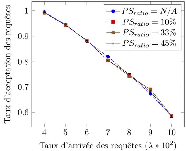
(d) Taux d'acceptation des requêtes en fonction du taux d'arrivée -  $\alpha = 150$ FIGURE 3.12 – Taux d'acceptation des requêtes de type **unicast** en fonction de leur taux d'arrivée et des paramètres de simulation
