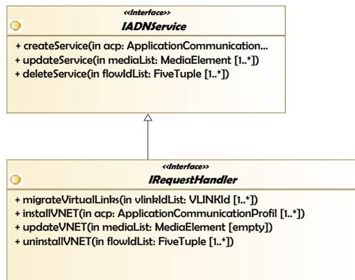
(b) L'interface de service du *Request Handler*FIGURE 2.7 – Modèle de service ADN et interface de service du *Request Handler*
