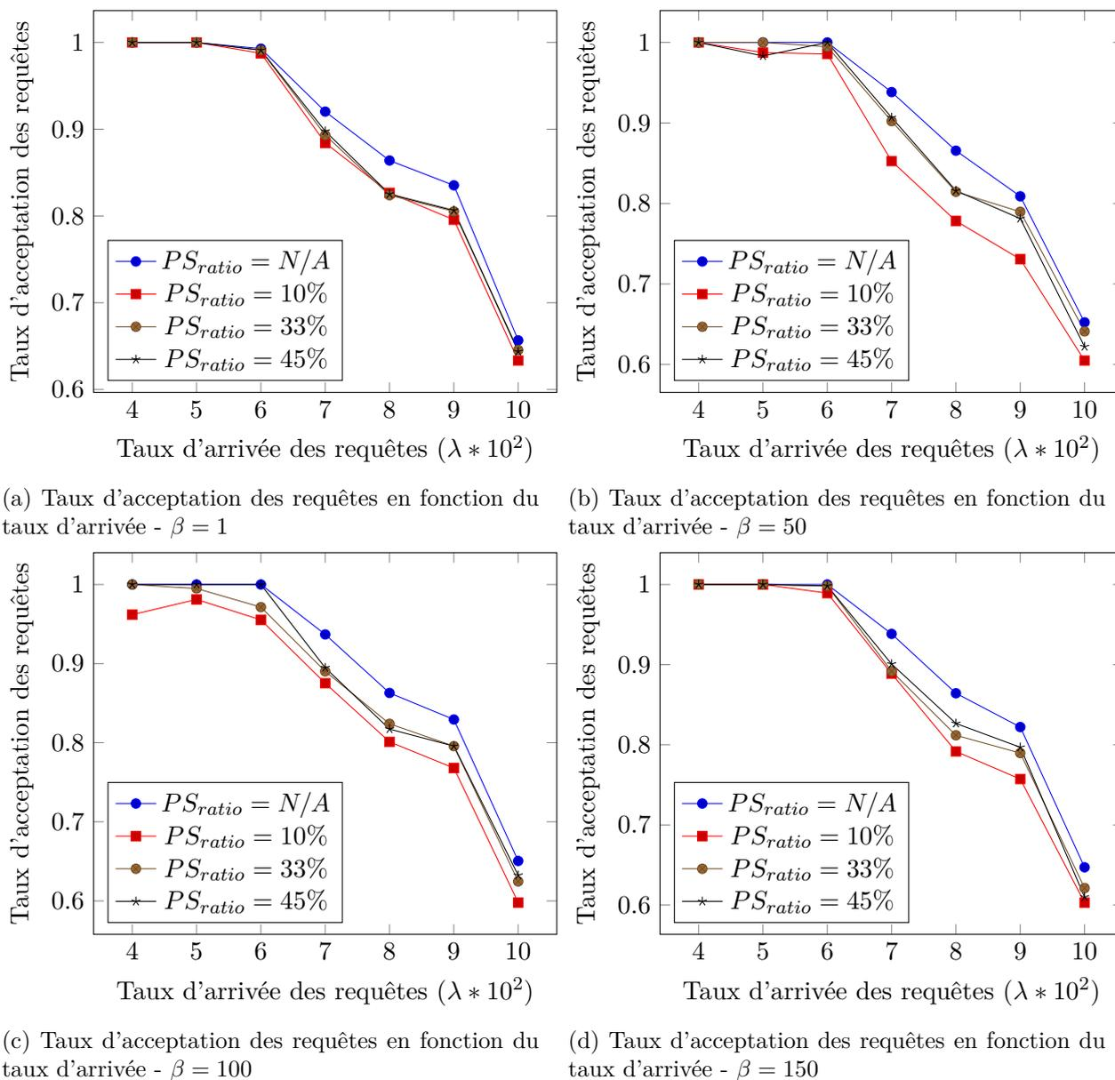
FIGURE 3.5 – Taux d'acceptation des requêtes de type **unicast** en fonction de leur taux d'arrivée et des paramètres de simulation
