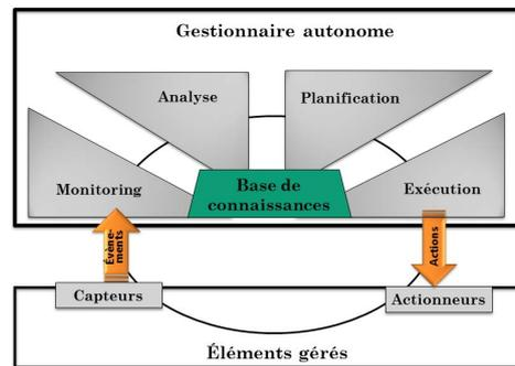
FIGURE 2.12 – Boucle de contrôle autonome MAPE-K (IBM 2006)
