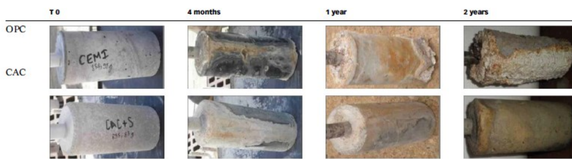
Figure 33. Evolution visuelle du CEM I/Sil et CAC/Sil exposé sur le site 2 durant 2 ans (Herisson et al., 2014).
