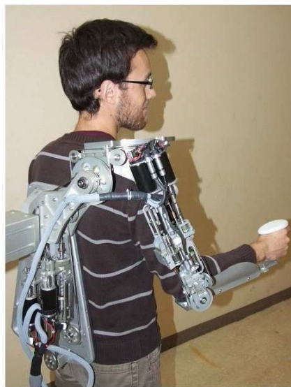
FIGURE 2.3 – Co-manipulation exosquelette pour la rééducation du bras [42].
