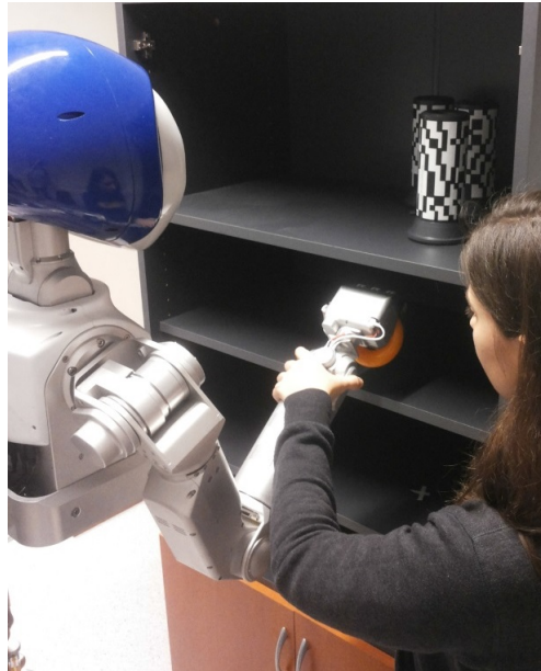
FIGURE 2.12 – Placement d’objets dans un placard à l’aide de guides virtuels pour éviter les collisions avec les étagères [68].
