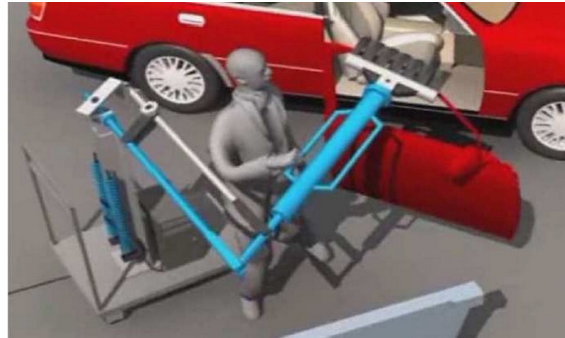
FIGURE 2.2 – Un ouvrier en co-manipulation avec un robot pour une opération de montage dans l'industrie.
