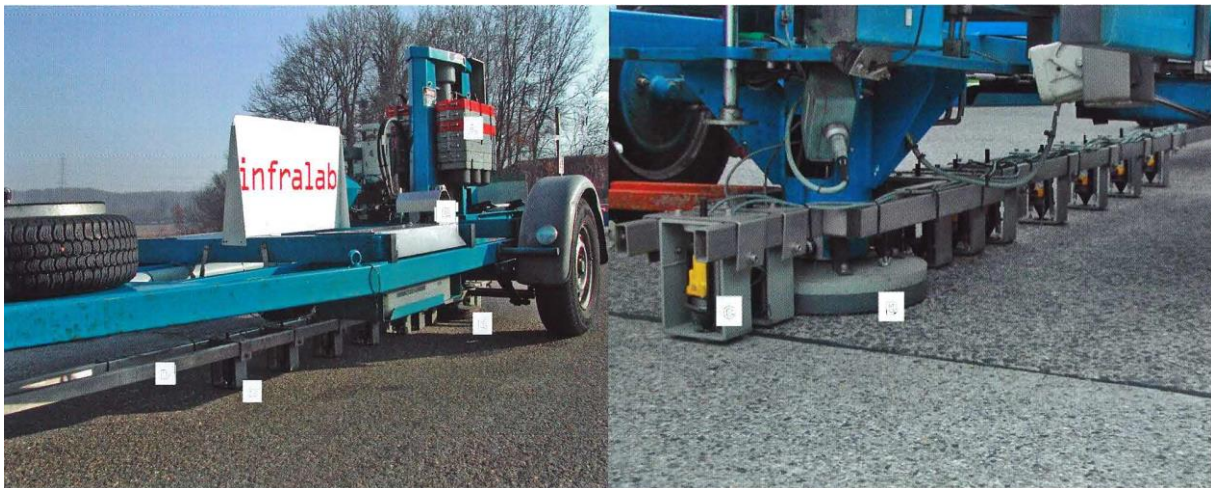
Figure I-9: Vue générale d'un FWD (Braber & Henia, 2008).
