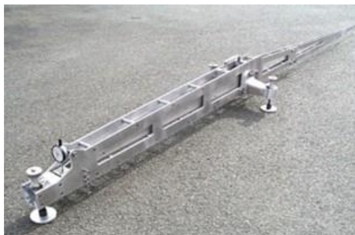
Figure I-11: Poutre de Benkelman.
