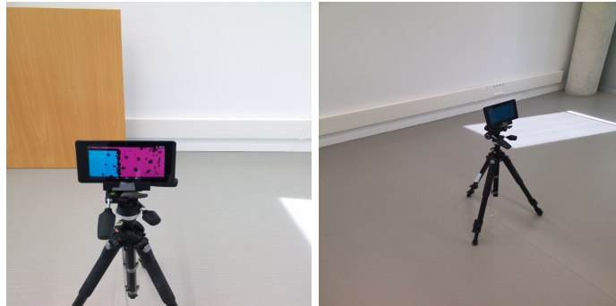
Figure 4.8 – Montage expérimental pour évaluer la détection des plans : deux plans parallèles (le mur et la table) sont placés à la verticale devant la tablette.
