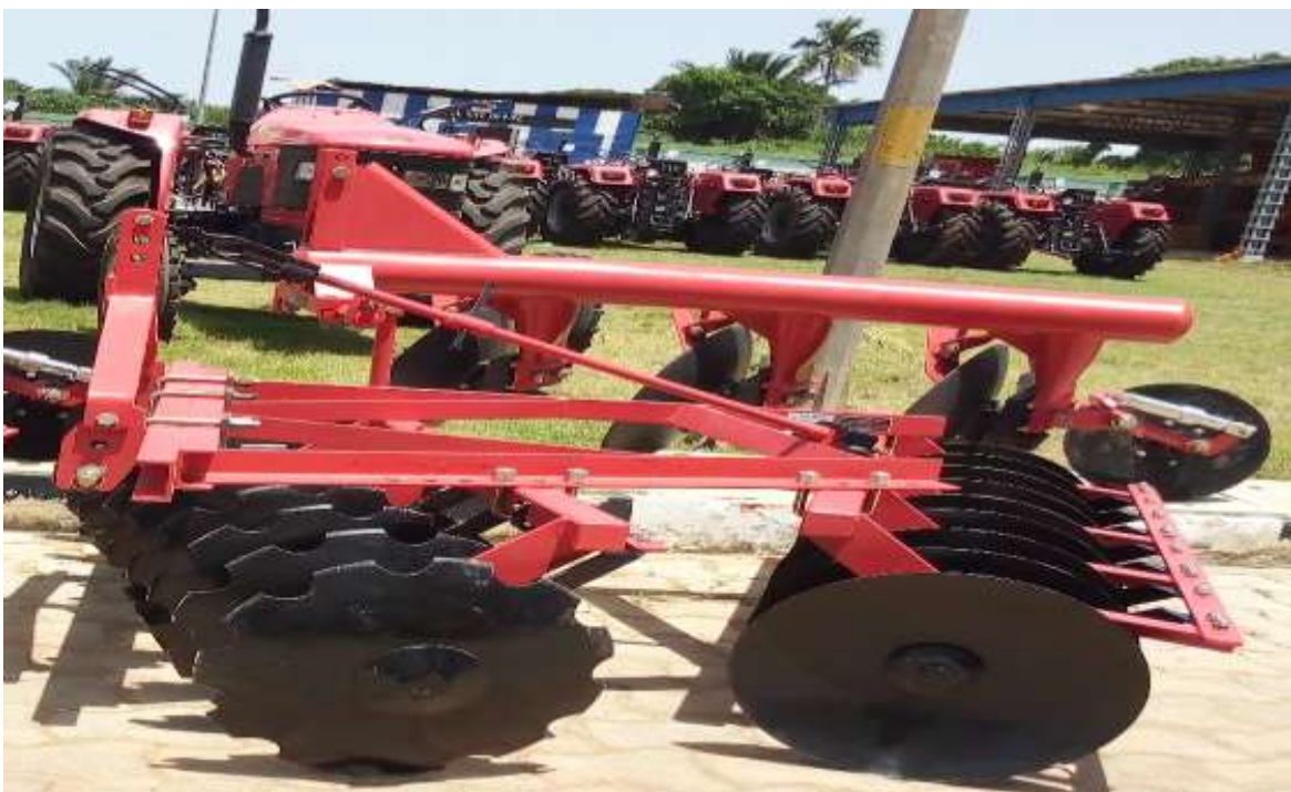
Figure 24 : Socs de tracteurs non adaptés à l'essouchage et à l'extirpation des racines d'arbres.
