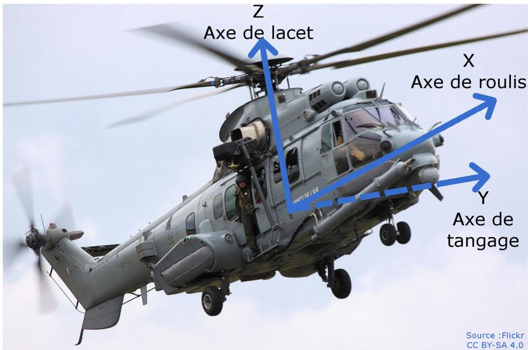
FIGURE 3.9 – Axes principaux des aéronefs.
