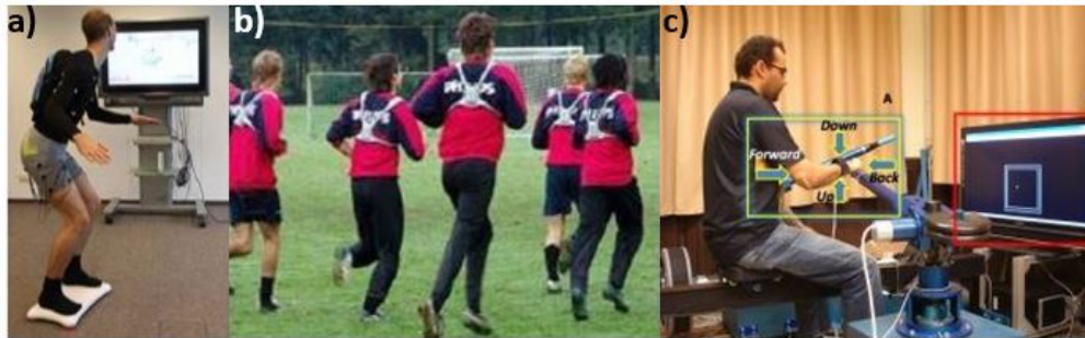
FIGURE 3.3 – a) Simulateur de snowboard. Les sujets sont équipés de capteurs optiques pour évaluer leur posture et de moteurs vibrants pour leur indiquer leurs erreurs [78]; b) ceinture vibro-tactile pour guider les joueurs sur le terrain [79]; c) amélioration de la séquence de ramage en aviron, dans le cadre jaune se trouve le guidage vibro-tactile et dans le cadre rouge le retour visuel [81].
