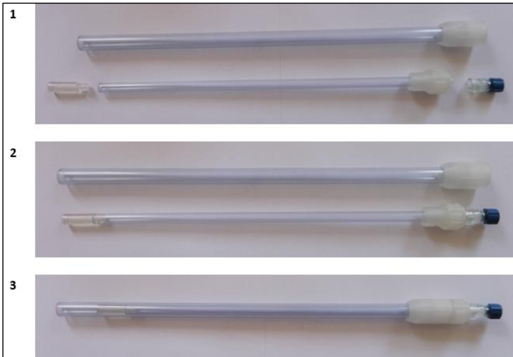
Figure 48 : Baguette lumineuse INSERM U 1189 : 1 : composants de la baguette détachés ; 2 : tube interne, luer lock et embout assemblés ; 3 : baguette lumineuse assemblée
