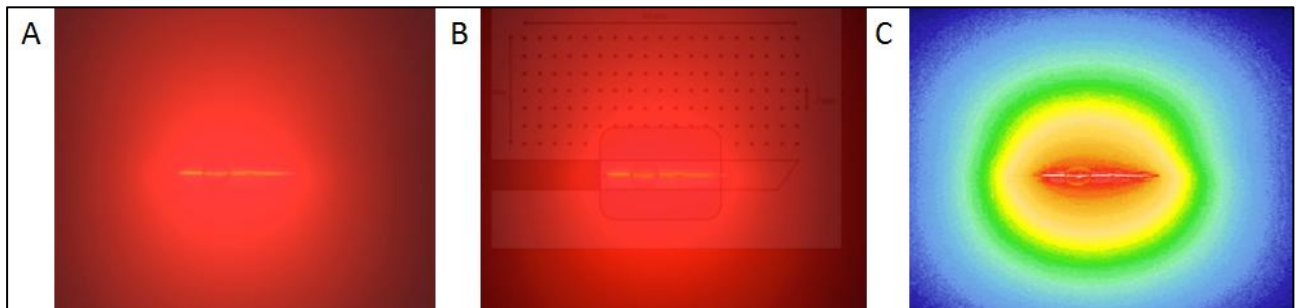
Figure 28 : Photographie du dispositif lumineux ;A : photographie initiale, B : correspondance avec les mesures ponctuelles de puissance, C : transformation par le logiciel Optical Profiler
