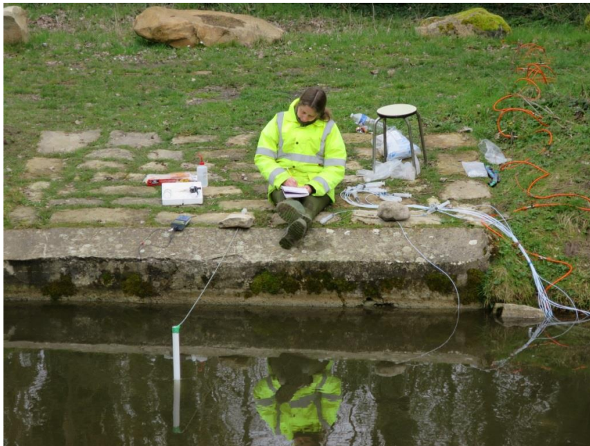
Figure 6-2 : Vue de l'un des opérateurs en train de réaliser les mesures géochimiques. On aperçoit un piézomètre installé dans les sédiments de la rivière (avec le marquage vert) et équipé d'une rallonge en téflon pour le prélèvement d'eau. Sur la droite de l'image, on peut voir les rallonges en téflon reliées au dispositif P1 et équipées de seringues pour l'échantillonnage de l'eau. La ligne d'électrodes ERT 1 est visible le long du câble orange.
