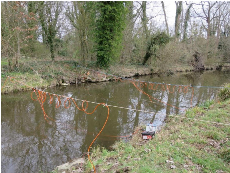
Figure 6-4 : Photographie des deux lignes électriques avec les connexions fixées hors de l'eau sur des cordes entre les deux berges.
