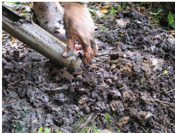
Figure A1 3 : Photographie de la tourbe atteinte au bout de 1 à 2 mètres de sondage à la tarière au niveau des berges.
