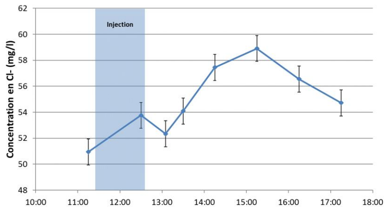
Figure 6-20 : Évolution temporelle de la concentration en chlorures dans le piézomètre ZH-30cm le jour de l'expérience d'injection.
