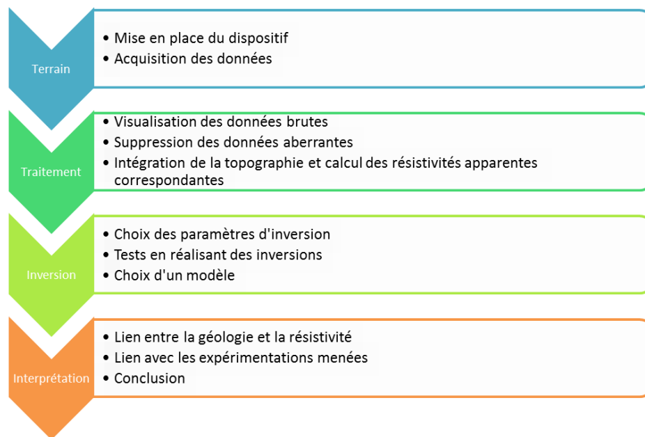
Figure 2-8 : Schéma récapitulatif de la séquence d'acquisition, inversion et traitement des données de résistivité électrique.
