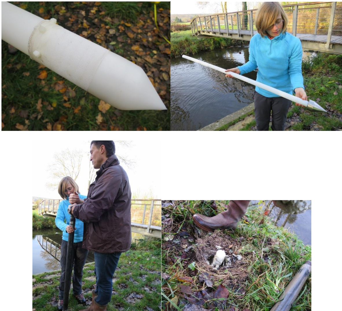
Figure A1 1 : Photographie de l'installation des piézomètres de bordure. En haut, présentation de deux types de piézomètres utilisés, avec pointe PVC ou métallique à l'extrémité du tube PVC crépiné en bas sur 5 cm. En bas, mise en place du système métallique d'enfoncement du piézomètre. Une fois installé, le piézomètre est protégé par un bouchon.
