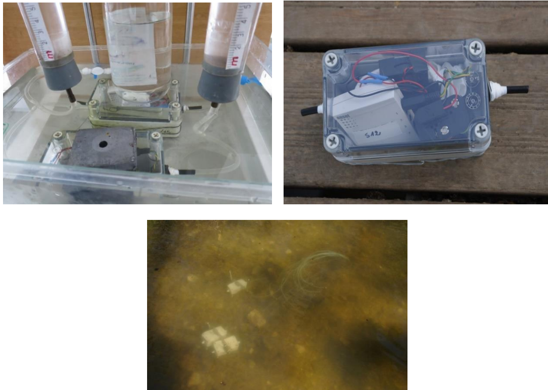
Figure 4-14 : Calibration des capteurs de pression au laboratoire et mise en place des capteurs dans une boîte étanche. L'une des extrémités est reliée à la rivière, l'autre à un tube inséré dans le sédiment. En bas, vue des capteurs une fois installés au fond du lit de la rivière.
