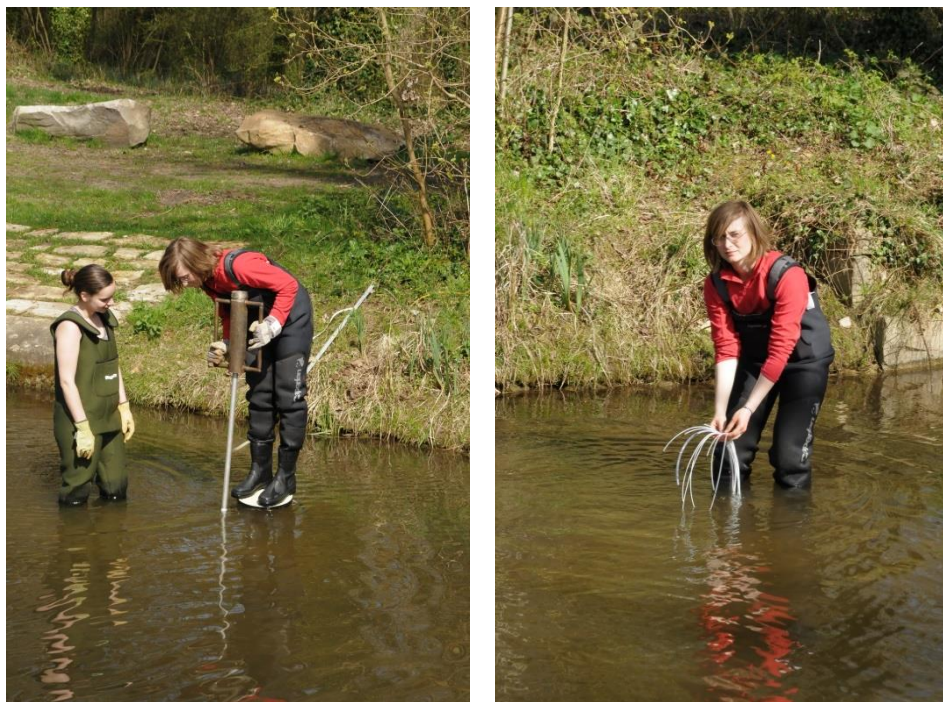
Figure 4-11 : Mise en place du système à l'aide d'un marteau-manchon. À droite, vue des tubes une fois installés au fond de la rivière.
