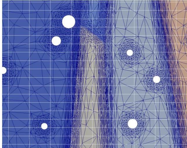
Figure V.18 : Maillage triangulaire éléments finis pour la modélisation par la méthode LevelSet [27]
