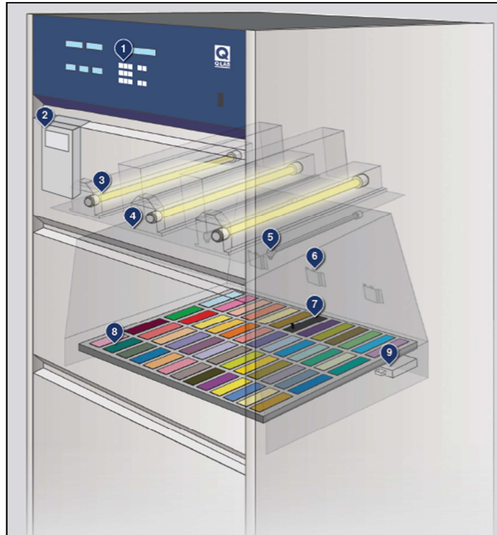
Figure 20 : Représentation schématique d'une enceinte Q-sun
