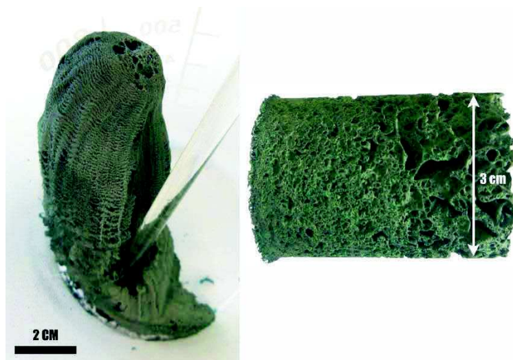
Figure 2 : Exemple de mousse de nanothermite (F-NT) brute (gauche), et moulée (droite)
