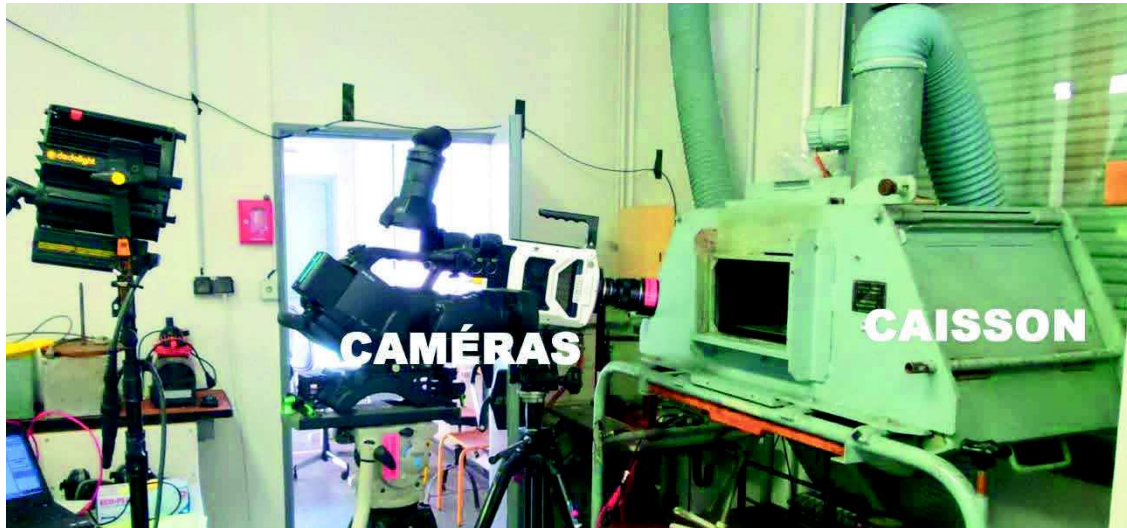
Figure 7 : Caisson de détonation timbré pour résister à la détonation de 3g d'équivalent TNT avec la caméra rapide (caméra blanche à gauche) en place pour filmer un tir
