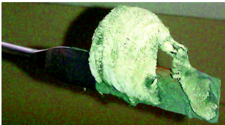
Figure 1 : Résidu de combustion du mélange aluminium/acide orthophosphorique/Cab-O-Sil M5 dont la morphologie illustre la forte expansion de la matière au cours de la combustion
