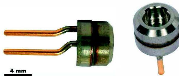
Figure 12 : Allumeur d'airbag (vide) servant, après remplissage avec une composition nano-Bi<sub>2</sub>O<sub>3</sub>/nano-B puis nano-WO<sub>3</sub>/nano-Al, à l'allumage des tests en tube
