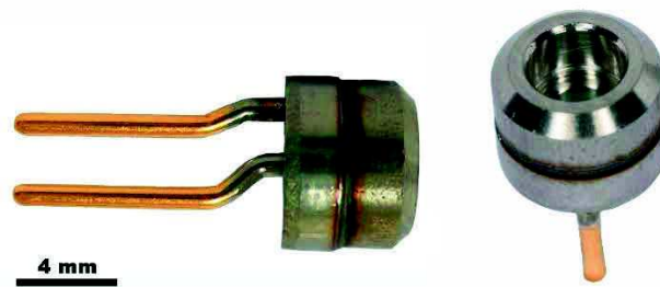
Figure 12 : Allumeur d'airbag (vide) servant, après remplissage avec une composition nano-Bi 2 O 3 /nano-B puis nano-WO 3 /nano-Al, à l'allumage des tests en tube
