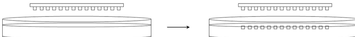
Figure 37: Schéma représentatif du moulage des micro-puits d'agarose
