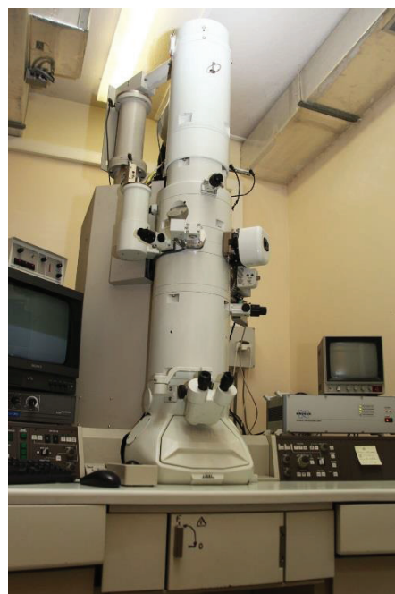
Figure II.4. Photo du MET JEOL 2010 disponible à l'IRCELYON.
