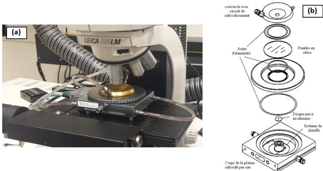
Figure III-3 : (a) Platine chauffante Linkam TS 1500 placée sous le spectromètre Raman. (b) Schéma des éléments constitutifs de la cellule [181].
