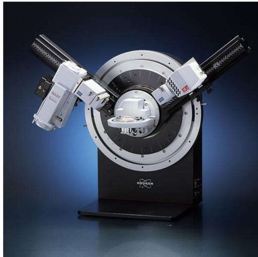
FIGURE 2.14 – Système interne de l'appareil de DRX D8 Advance, Bruker
