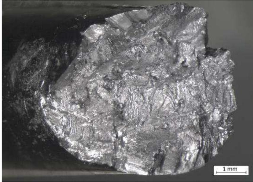
Figure IV. 3: *faciès de rupture de l'éprouvette de comportement cyclique pour le TA6V 6 vieillie 1000 h à 350°C*
