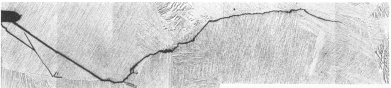
Figure I. 42: étapes de la propagation de fissure dans l'étude de Brown et Hicks [36]: mécanisme cristallographique trans-colonie puis propagation le long des joints de colonies de lamelles (échelle non disponible)
