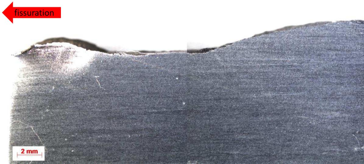
Figure III. 25: texture fine mise en évidence par l'oxydation sur l'éprouvette de Ti6242 à l'état de réception testée à 450°C
