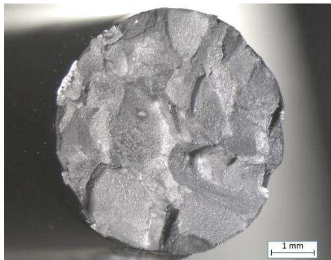
Figure IV. 5: faciès de rupture de l'éprouvette de Ti 17 vieillie 1000 h à 350°C testée à température ambiante
