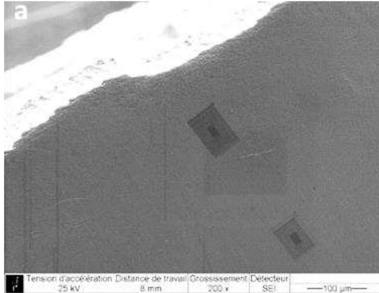
Figure V. 27: illustration du caractère fortement localisé de la déformation dans l'éprouvette vieillie 10 000 h à 450°C : la rupture se produit à proximité des zones d'observation (rectangles sombres chargés par le faisceau du MEB), ces dernières ne voyant pourtant que peu de déformation plastique.
