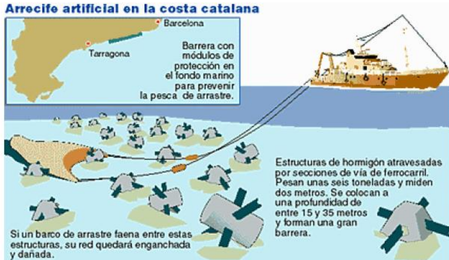
Figure 3 : Principe d'utilisation des RA de lutte contre le braconnage de chaluts illégaux dans les zones côtières destinées à la pêche artisanale (e.g. en Catalogne extrait du quotidien « El Pais », Espagne, 2003)
