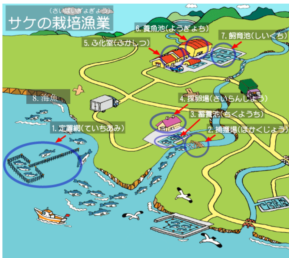
Figure 27 : Les étapes du repeuplement en saumon au Japon, de la capture des adultes à l'entrée des fleuves, à l'élevage en éclosérie à terre, jusqu'au réensemencement en mer des juvéniles avant un nouveau cycle quadri annuel, source www.salmon.affrc.go.jp/zousyoku/
