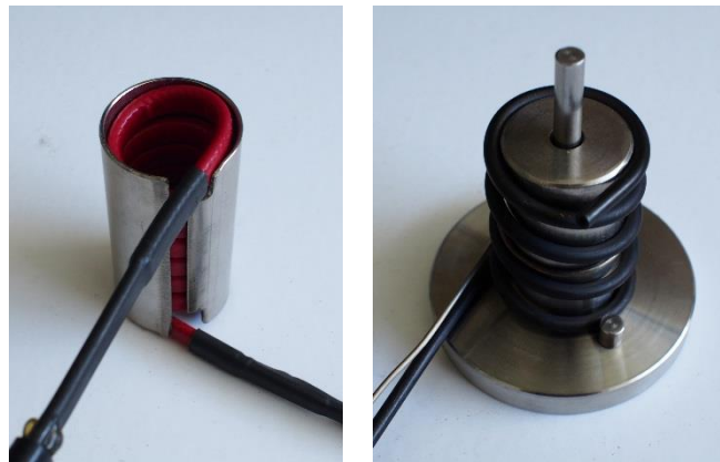
Figure 26. À gauche : gaine chauffante utilisée lors d'essais préliminaires. À droite, le système retenu.
