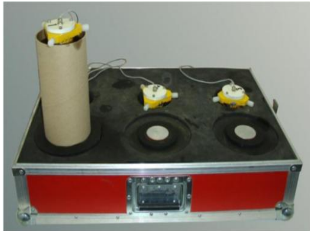
Figure III.1-1 : Système de mesure BT PULS permettant la mesure du module d'Young dynamique [Delsaute, et al., 2016].
