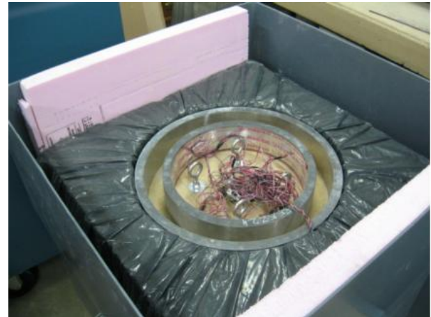
Figure III.1-35 : Photographie du dispositif d'isolation thermique de l'anneau [Schlitter, et al., 2010].
