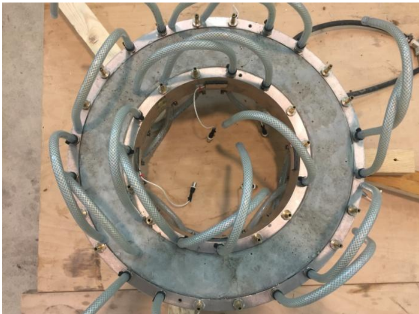
Figure III.1-53 : Fissuration observée de l'anneau R1bis.
