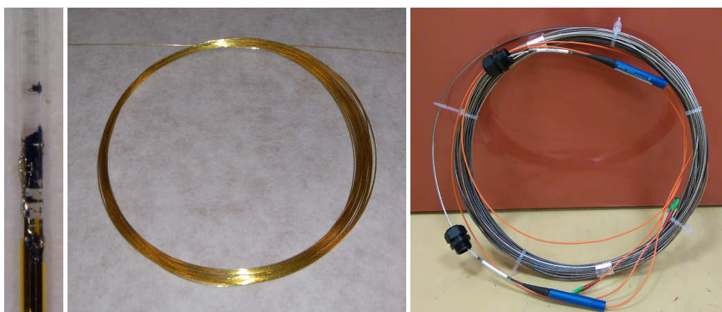
FIGURE 1.39 – Fibre à revêtement or saut d'indice 50/125 \mu\text{m} partiellement dénudée (gauche, \varnothing_{\text{revêtement}} \approx 155 \mu\text{m} ), et avec revêtement (milieu, \varnothing_{\text{bobine}} \approx 5 cm) est insérée dans la protection FIMT et connectorisée en E2000-APC (droite, \varnothing_{\text{bobine}} \approx 35 cm).
