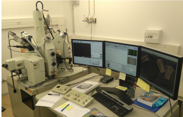
FIGURE 2.23 – EPMA JEOL JXA-8230 SuperProbe à gauche et sa station d’acquisition et de traitement de données à droite (laboratoire ISTerre, Grenoble).
