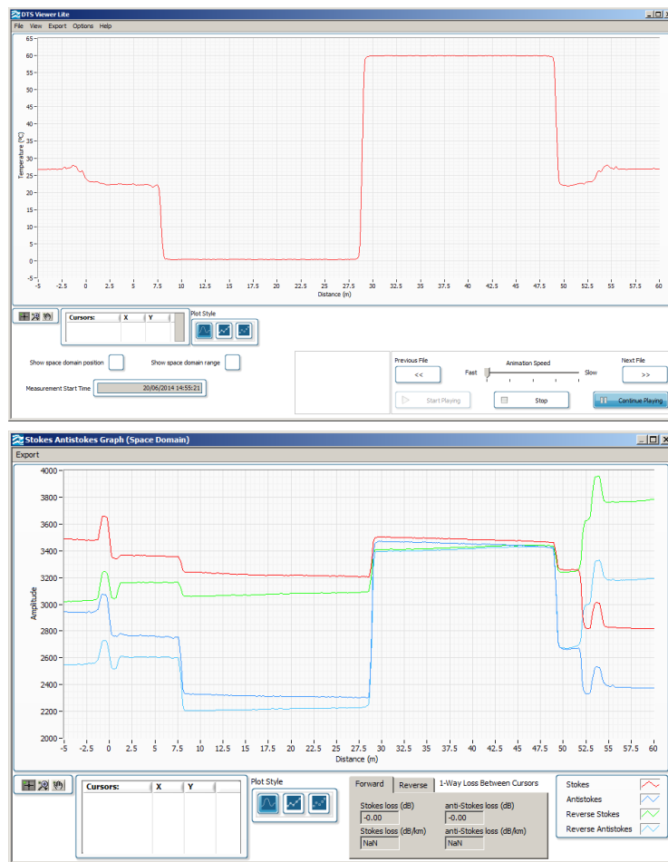
FIGURE 1.24 – Visualisation de la température calculée (gauche) en mode double-ended par le logiciel DTS Viewer de Silixa. Un exemple de saut de température est affiché. Les signaux bruts Stokes et anti-Stokes depuis lesquels la température est calculée sont visibles dans les deux sens de lecture (droite).
