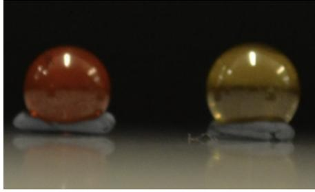
FIGURE 1.1 – Photographie de cristaux de  $\text{Ho}_2\text{Ti}_2\text{O}_7$  (gauche) et  $\text{Dy}_2\text{Ti}_2\text{O}_7$  (droite). Les cristaux ont été taillés en sphère par un bijoutier londonien afin d’avoir un bon contrôle sur le champ de désaimantation. Ce dernier a en effet la propriété d’être homogène et proportionnel au champ appliqué pour cette géométrie. La photographie est empruntée à [Bovo *et al.*, 2013].
