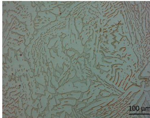
Figure 92 : Microstructure d'un acier duplex après polissage et attaque chimique, en sombre la ferrite.
