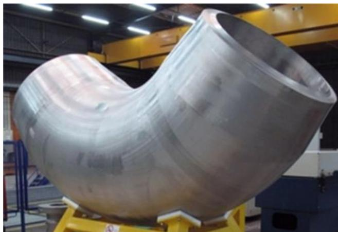
**Figure 2 : Exemple d'un coude moulé (7 tonnes) [3]**
