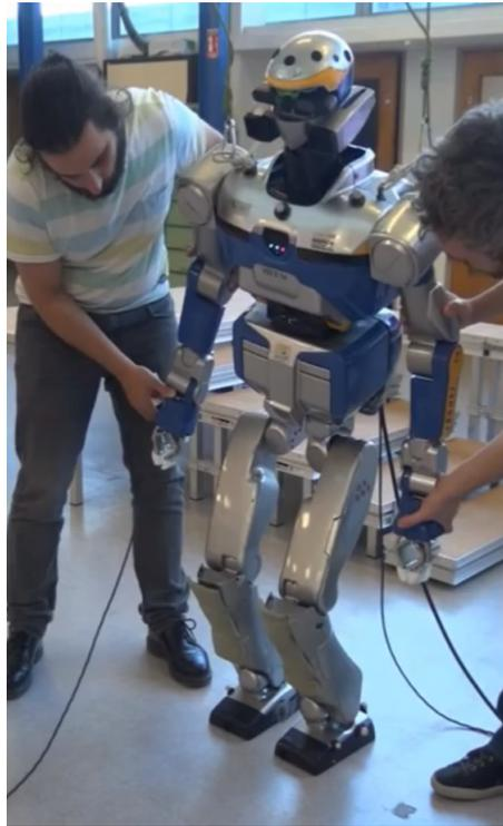
FIGURE 3.8 – Tests d'interaction avec HRP-2 contrôlé en couple
