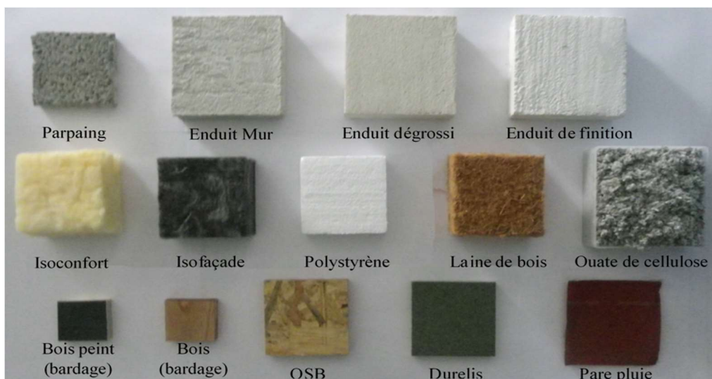
Figure II-3 : Aperçu des matériaux utilisés pour la caractérisation thermohydrigue.
