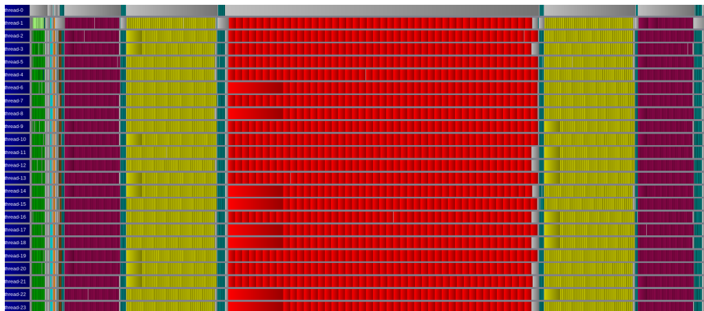
FIGURE 7.5 – Extrait de la trace d’une exécution sur un maillage de (256 \times 256 \times 32 \times 32) points (réduit en r \times \theta ) avec un processus MPI. Zoom sur une itération. Runtime INTEL.
