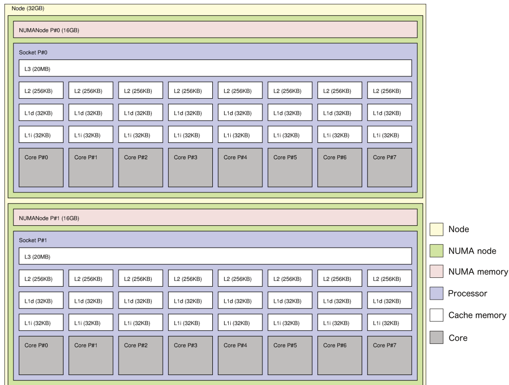
FIGURE 1.6 – Représentation d'un nœud de calcul sur le calculateur Poincaré donnée par l'outil hwloc (commande lstopo ).
