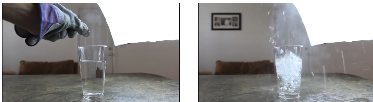
FIGURE 1.1 – Apparition de bulles de vapeur dans un verre d'eau surchauffée au micro-ondes. À gauche on a le verre d'eau contenant de l'eau liquide avant l'ajout de la pièce métallique. À droite, on observe une explosion et l'apparition spontanée des bulles de vapeur dans le même verre d'eau dès l'introduction de la pièce métallique. Vidéo correspondante https://youtu.be/Kq07AgcqzQ0 .
