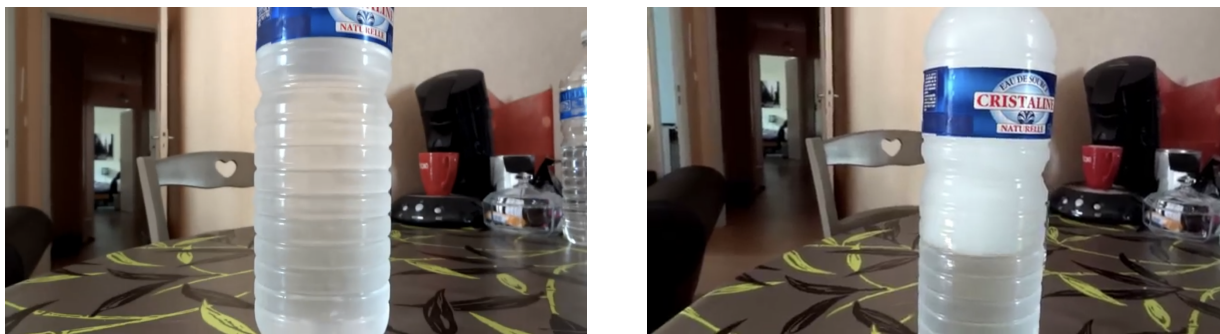
FIGURE 1.2 – Solidification brutale de l'eau à une température inférieure à 0^{\circ}\text{C} . À gauche on a une bouteille d'eau froide en état liquide. À droite on observe l'apparition de la glace dans la bouteille une fois agitée. Vidéo correspondante https://youtu.be/NG0c9bFNk1U .
