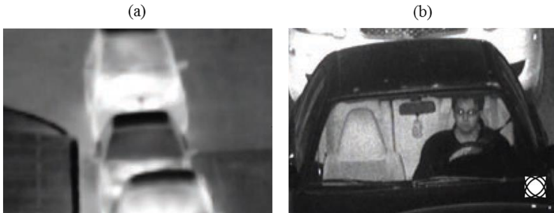
Figure 1-7 : (a) Imagerie thermique d'un véhicule à 330 m. (b) Imagerie active à 1,55 \mu\text{m} de ce véhicule. L'identification d'un individu à l'intérieur de la voiture est alors possible [16].
