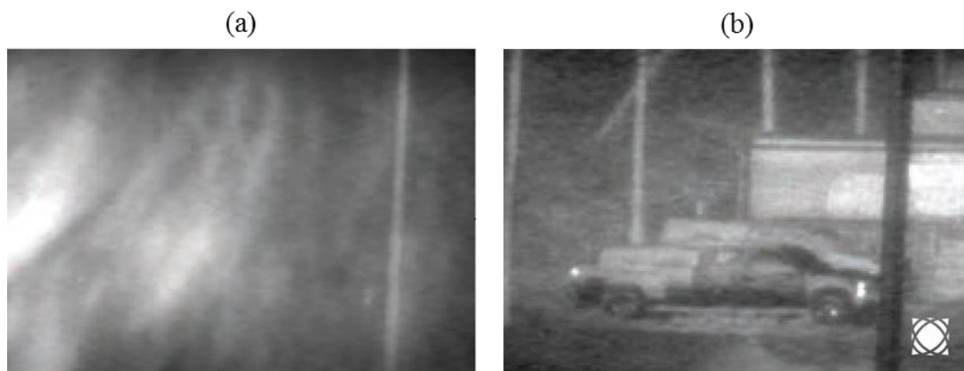
Figure 1-6 : Observation de véhicules à 500 m sous des chutes de neiges, avec un système d'imagerie active à 1,55 \mu\text{m} . (a) La détection est continue et le système est aveuglé par la rétrodiffusion sur la neige. (b) Le crénelage temporel est utilisé, faisant apparaître la scène d'intérêt à travers la neige [15].
