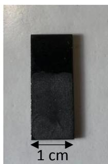
*Figure II-VII : électrode de travail en carbone vitreux*
