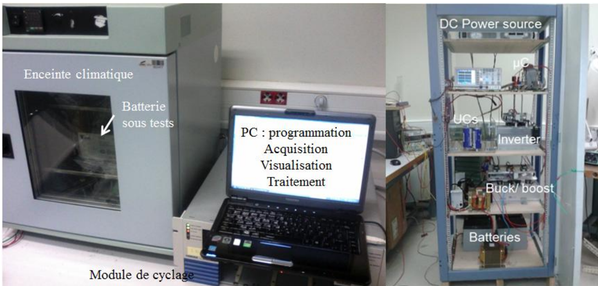
Photo III-1: Banc de tests expérimentaux de cyclage des unités de stockage :
