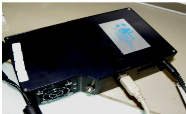
Figure II.22 : Spectromètre QE65000 utilisé pour mesurer les spectres d'absorption
