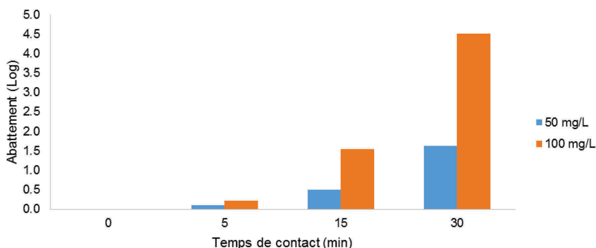
Figure III.1: influence de la concentration en H 2 O 2 (50 et 100 mg/L) sur l'abattement d'une souche d' E. coli sauvage dans l'eau du réseau.
