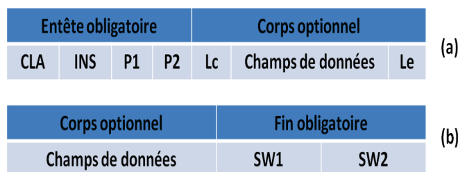
Figure IV.6 : Commande APDU (a) et réponse APDU (b)
