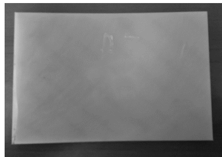
Figure 5.20 : Epreuve de flexion (135 x 90 mm 2 ) découpée dans un renfort du Renault Scénic IV vue de dessous, face incurvée vers le haut.
