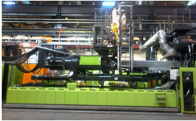
Figure 1.3 : Presse d'injection de renforts composites à l'usine de Douai – données Renault.
