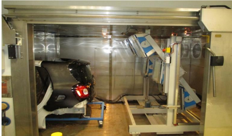
Figure 1.7 : Hayon composite sur bâti dans une étuve du Centre Technique de Lardy.
