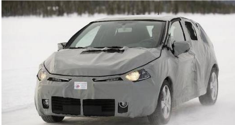
Figure 1.4 : Essais climatiques de la Clio 4 sur des pistes d'essais en Laponie où la température hivernale est comprise entre -40^{\circ}\text{C} et 0^{\circ}\text{C} (Chevalier, 2012).
