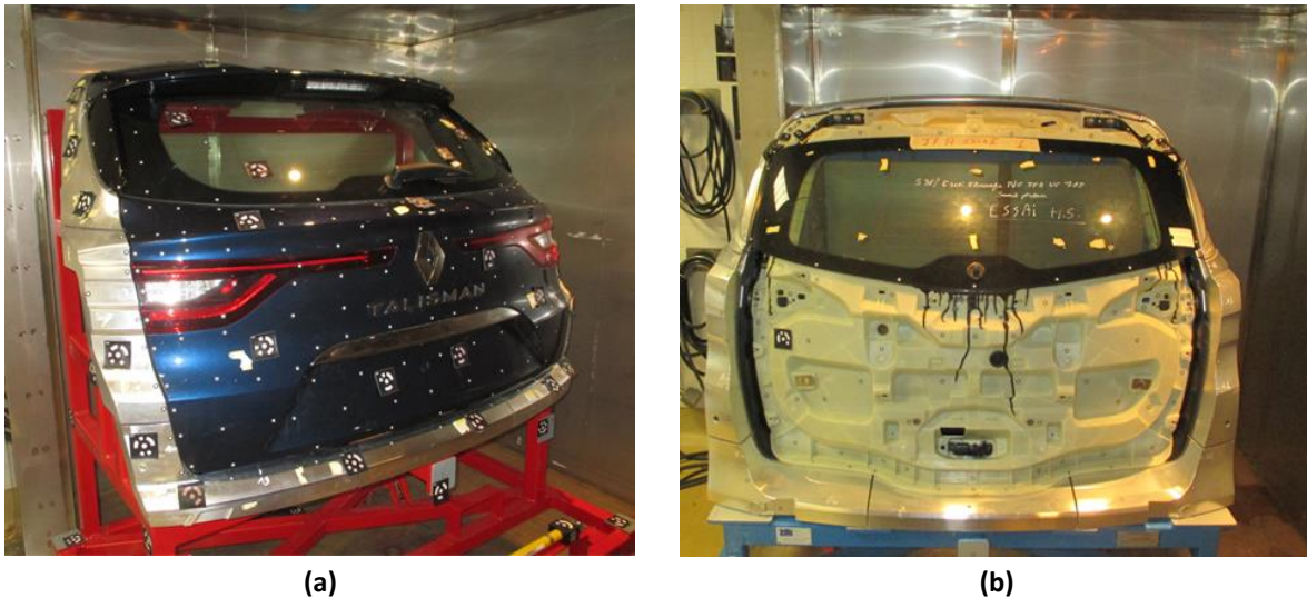
Figure 1.5 : Hayon composite (a) et renfort de hayon de 1,19 m de large (b) sur bâti rigide au Centre Technique de Lardy.
