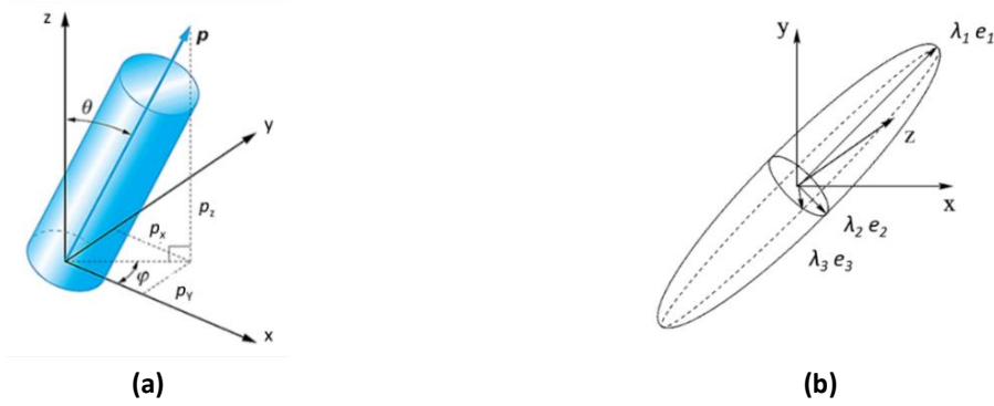
Figure 2.5 : Définition des angles (\theta, \phi) et du vecteur \underline{p} dans un repère global (Vincent 2003) (a) et ellipse utilisée pour la représentation du tenseur \underline{a}_2 proposé par (Advani and Tucker III 1987) (b).
