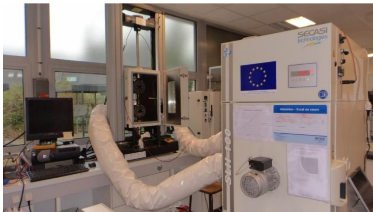
Figure 3.21 : Dispositif expérimental à l'IRDL avec enceinte thermique.
