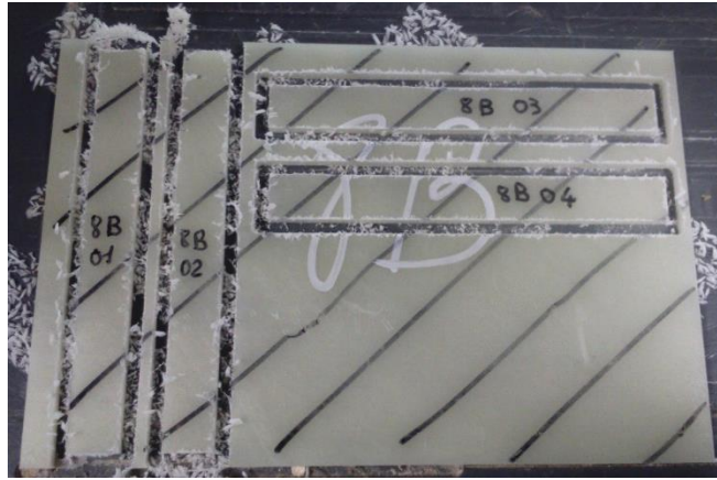
Figure 5.22 : Zones de découpe des éprouvettes prélevées sur une plaque de flexion (90 x 135 mm 2 ) selon deux directions en position 1, 2, 3 et 4.
