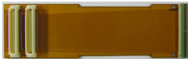
FIGURE 1.5.6 – SiPM monté sur un Kapton flex-PCB avec des connecteurs pour l’électronique FE.
