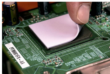
FIGURE 5.2.2 – Plaques élastomériques ou « PAD » - Image du fabricant Stacem.
