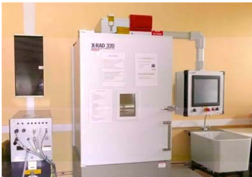
FIGURE 7.3.1 – Irradiateur à rayons X de la plate-forme PAVIRMA.
