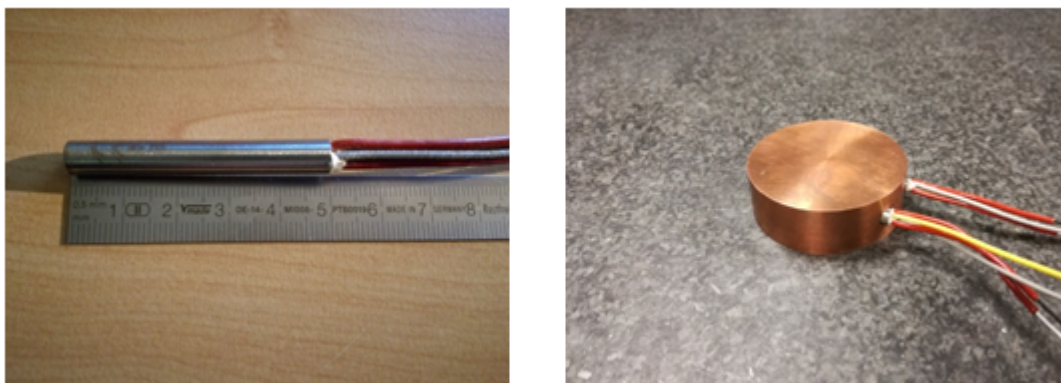
FIGURE 6.2.6 – Source chaude avec cartouches chauffantes.
