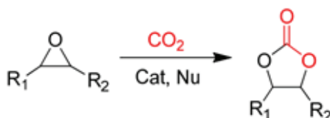
Schéma 1. Réaction d'addition de CO 2 sur des époxydes générant des carbonates cycliques à cinq chaînons utilisant un catalyseur métallique (Cat) et un Co-catalyseur (Nu ; nucléophile)
