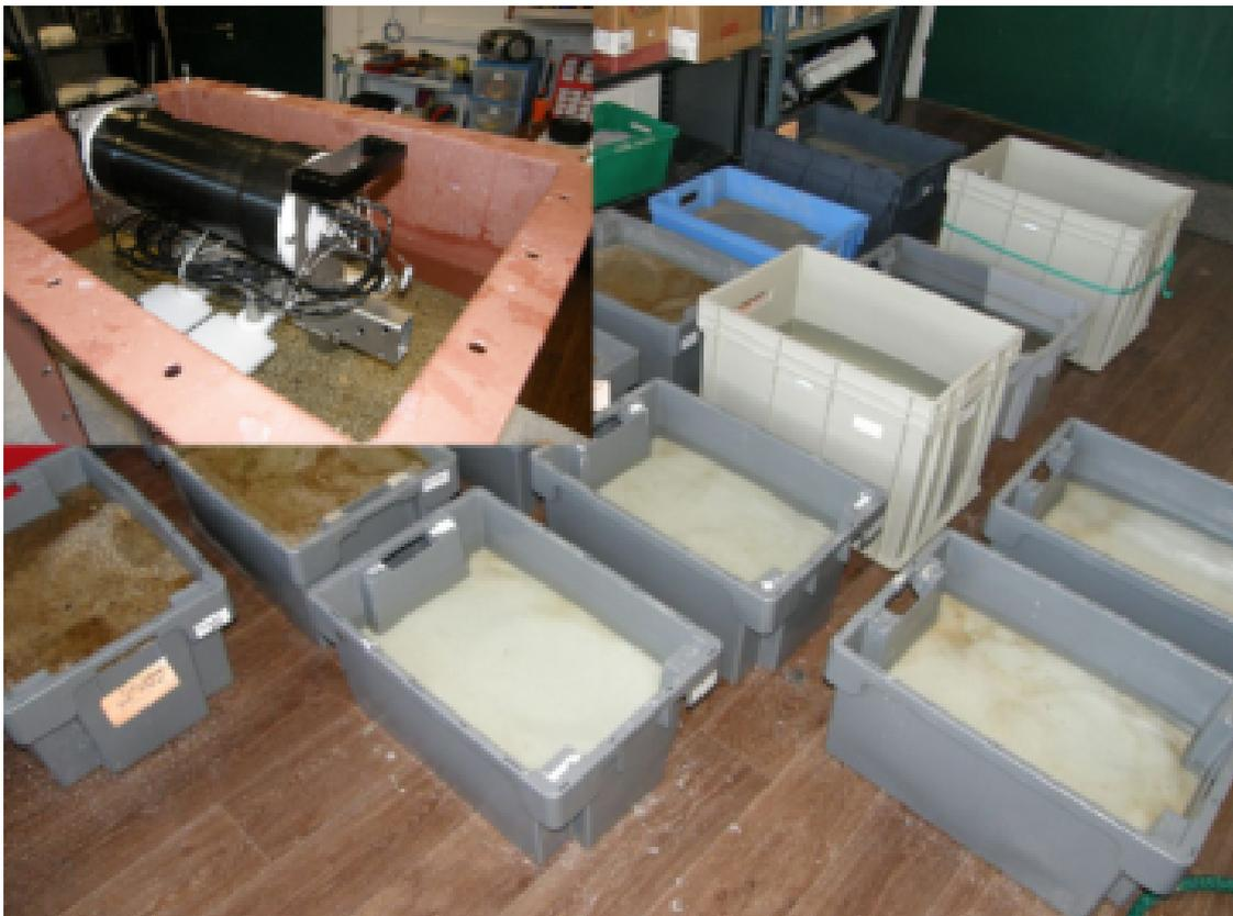
FIGURE 17 – Mesures en cuve à l'aide du célérimètre. Les mesures sont faites en laboratoire dans des bacs contenant les sables de mer prélevés sur les plages et remplis d'eau de mer. Un bac pèse entre 100 et 150 kg.
