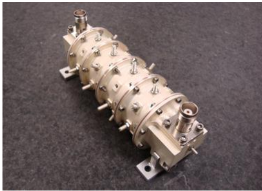
(a) Filtre circulaire en bande X a
