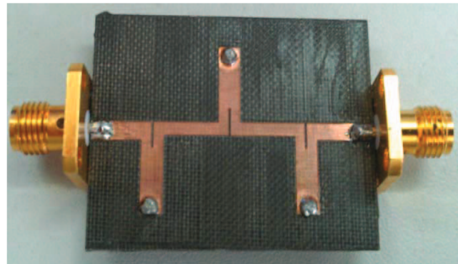
(b) Filtre à résonateurs quart d'onde d'ordre 5 [18]
