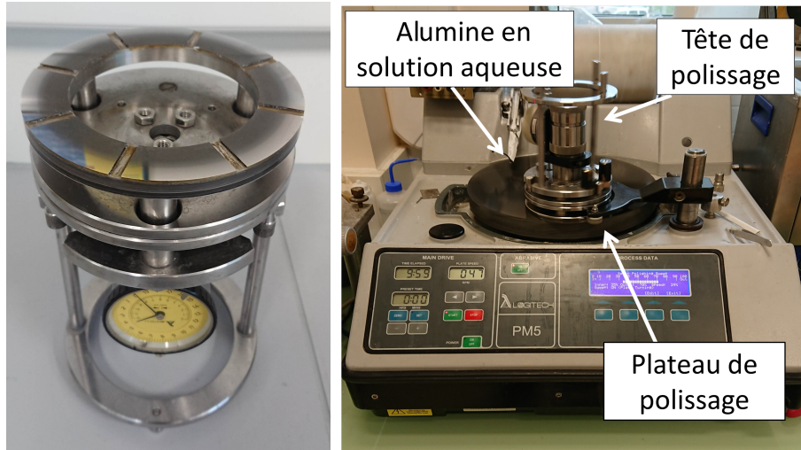
FIGURE 3.14 – Photo de la tête (gauche) et du plateau (droite) de polissage utilisés pour l’usinage des lames orientées.
