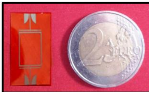
Figure A-2-structure fabriqué sur kapton
