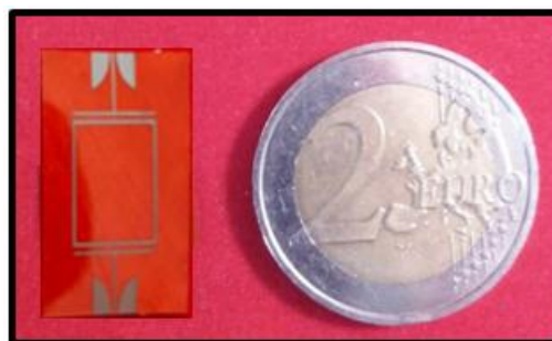
Figure A-2-structure fabriqué sur kapton
