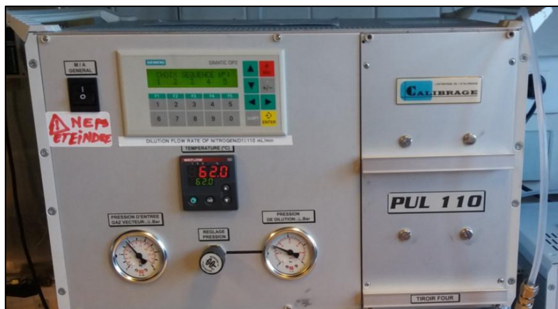
Figure III-33 - Générateur de vapeur (PULL 110)
