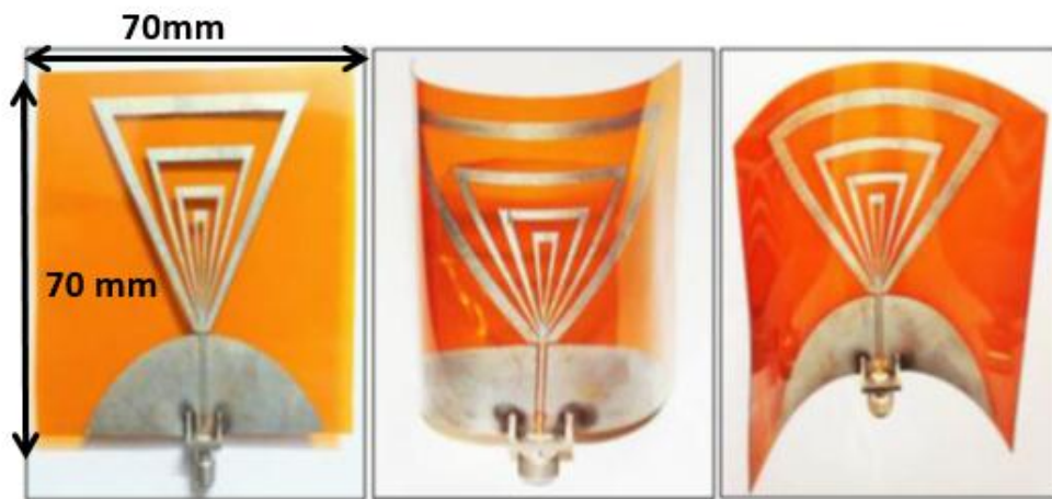
Figure II-7- Antenne fabriquée par jet d'encre sur un substrat de Kapton en différentes configurations [110]
