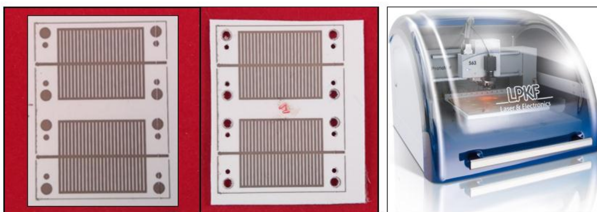
Figure III-28- Masque à percer (à gauche) et machine LPKF (à droite)
