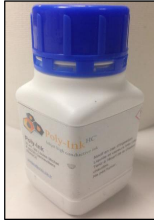
Figure II-18-Encre Polymère : PEDOT:PSS – MWCNTs
