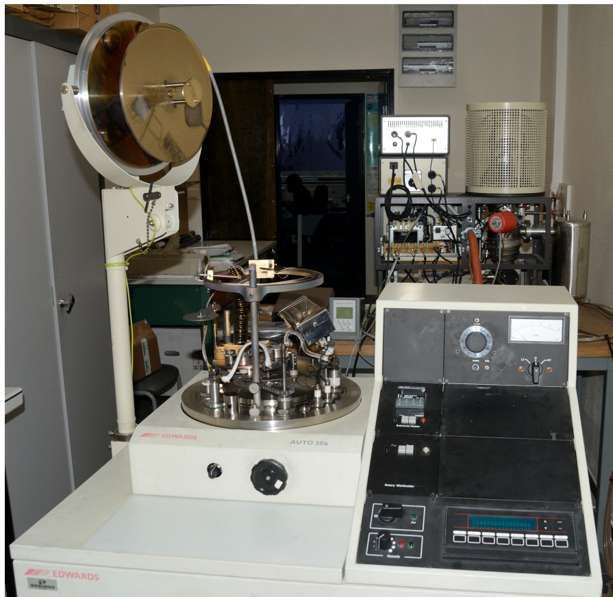
FIGURE 4.10 – Photographie de la cellule évaporatrice
